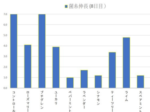
図4 各アロマ精油がスエヒロタケ菌糸の伸長に及ぼす影響(スエヒロタケの培養8日目)
